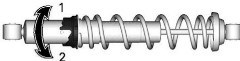
1. Vorspannung erhöhen
