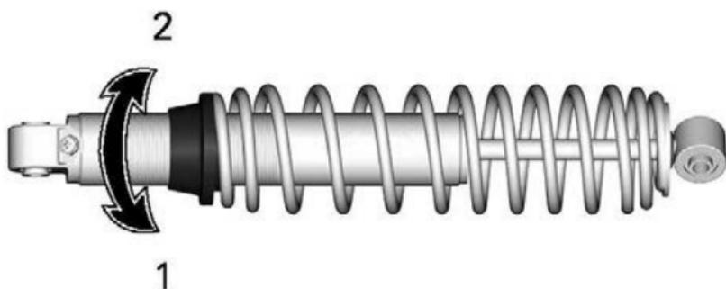
1. Vorspannung erhöhen
