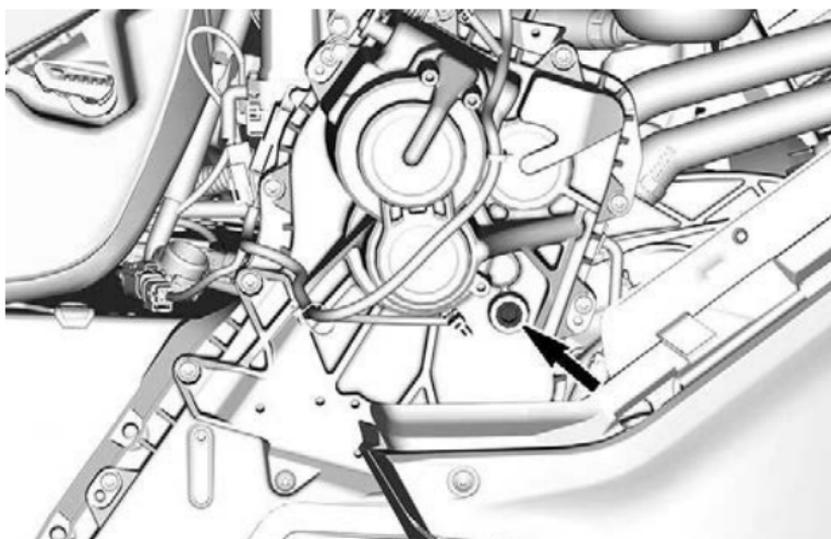
4. Befüllen Sie das Getriebe durch die Einfüllöffnung mit dem empfohlenen Öl, bis Öl aus der Kontrollschraubenbohrung austritt.
