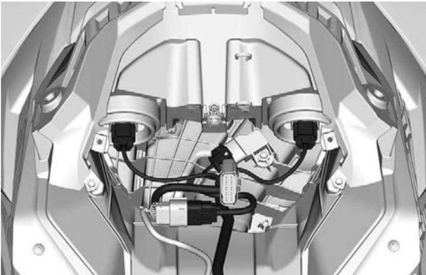
3. Lösen Sie die Schelle des Luftansaugschlauchs.
