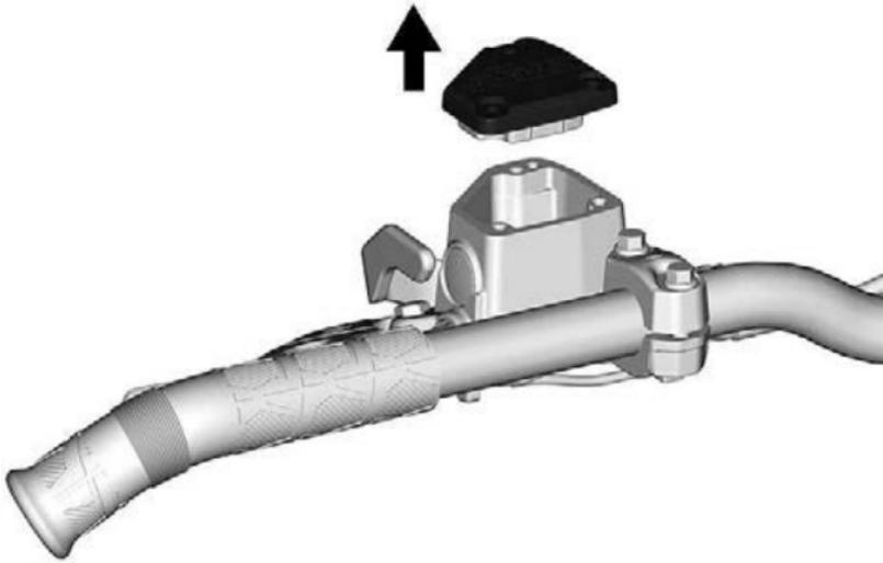
4. Füllen Sie Bremsflüssigkeit nach Bedarf auf. Nicht überfüllen. Verwenden Sie nur empfohlene Bremsflüssigkeit.
