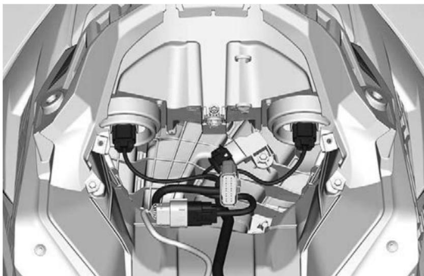
6. Falls vorhanden trennen Sie die 12 V-Steckverbinder, bevor Sie das Aufbewahrungsfach einbauen.
