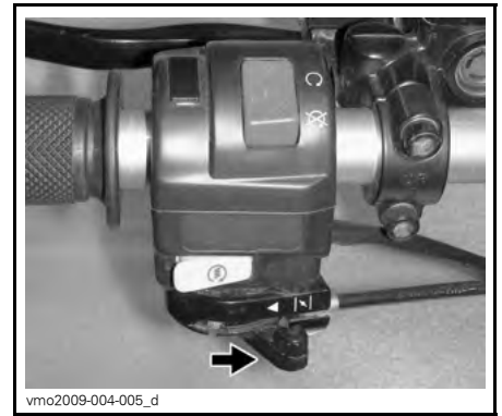
OFF (POIS PÄÄLTÄ) -ASENTO
