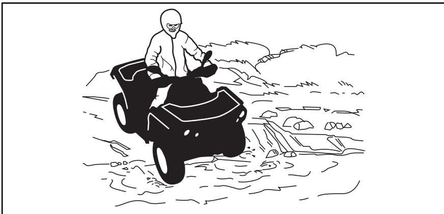
Si los frenos están húmedos, la capacidad de frenado del vehículo se ve afectada. Asegúrese de que se sequen los frenos; para ello, accíonelos varias veces después de salir del agua, del barro o de la nieve con el vehículo.
