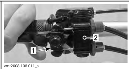
1. Joint de câble 2. Support de câble
