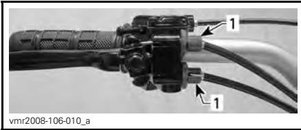
1. Vis de réglage sur le levier
