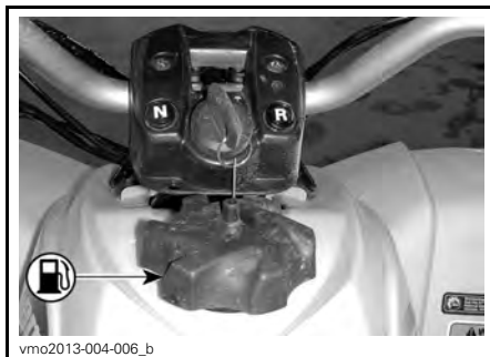
TYPIQUE — BOUCHON DU RÉSERVOIR D'ESSENCE
