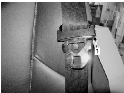
SITUAZIONE TIPICA - POSIZIONE BLOCCATA
