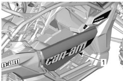
1. Porta fechada e corretamente travada
