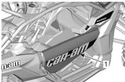
1. Porte fermée et verrouillée
