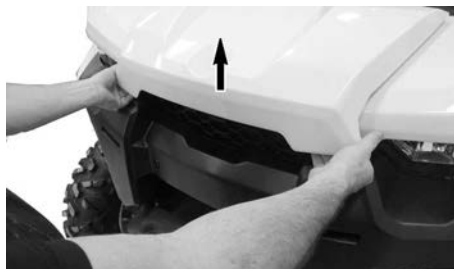
SOLLEVAMENTO DEL BORDO DEL COPERCHIO DI MANUTENZIONE ANTERIORE
