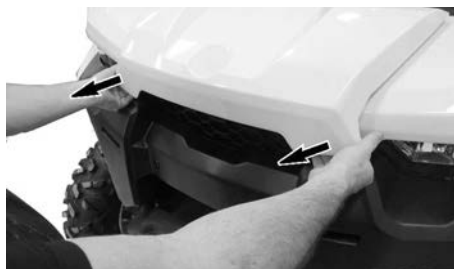
TIRARE DAL BORDO COPERCHIO DI MANUTENZIONE ANTERIORE.
