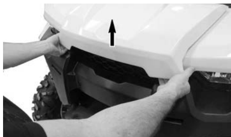
LEVANTAMIENTO DEL BORDE DE LA TAPA DE ACCESO DELANTERA.
