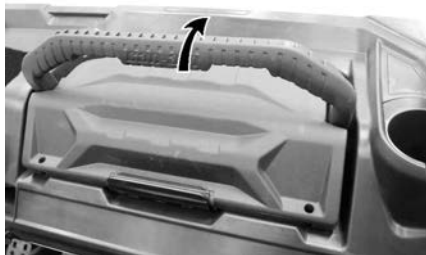
FIXAÇÃO DA CAIXA DE FERRAMENTAS NO LUGAR
