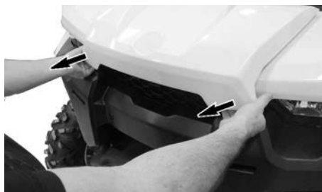
TIRARE DAL BORDO COPERCHIO DI MANUTENZIONE ANTERIORE.
