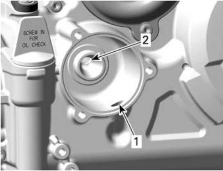
1. Einlass-Bohrung der Ölpumpe zum Ölfilter
