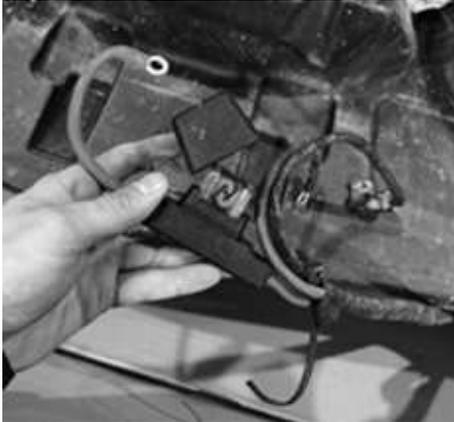
2. Prüfen Sie die Sicherung mit einem Durchgangsprüfer.
