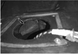
5. Nehmen Sie die Sicherungsabdeckung ab und tauschen Sie die durchgebrannte Sicherung aus. Bauen Sie alle zuvor ausgebauten Teile wieder ein.
