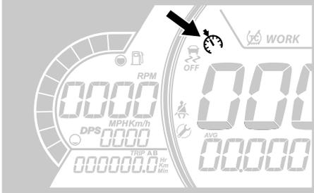
Bei Aktivierung des Geschwindigkeitsbegrenzungsmodus wird nur die verfügbare Höchstgeschwindigkeit bei Betätigung des Gaspedals beschränkt.
