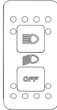
Mit diesem Schalter wird entweder die OFF-Stellung, das Abblendlicht oder das Fernlicht ausgewählt.
