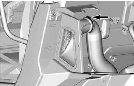
4. Entfernen Sie das Luftfiltergehäuse vom Fahrzeug.
