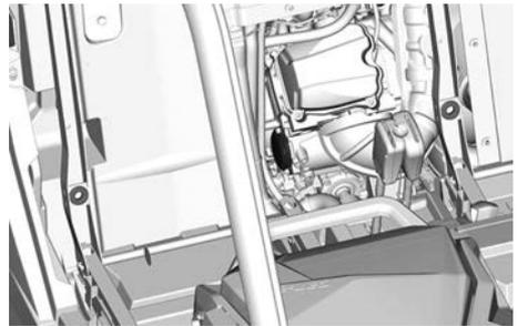
3. Entfernen Sie die Ölfilterabdeckung.
