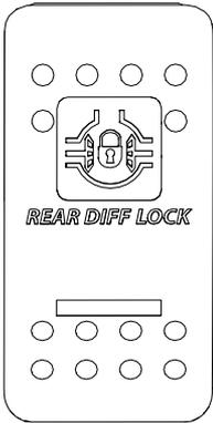
Mit dem Differenzialschalter wird das hintere Differential gesperrt.
