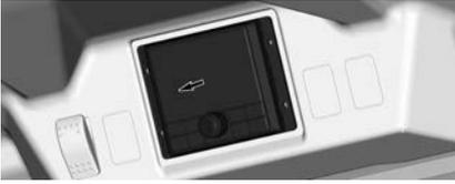
4. Ziehen Sie anschließend den Kabelstrang vorsichtig heraus und achten Sie dabei darauf, dass Kabel oder Verbindungen nicht beschädigt werden. Finden Sie die Sicherungsabdeckung.
