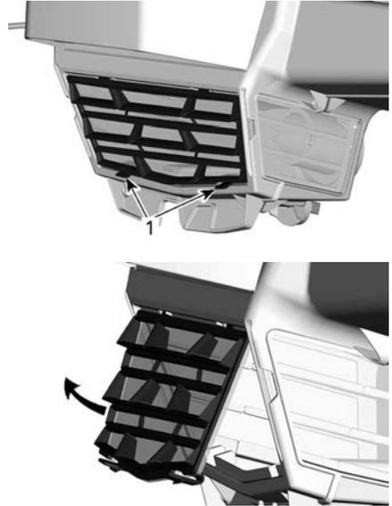
Reinigen Sie den Luftfilter, indem Sie ihn in einer Mischung aus lauwarmem Wasser und milder Seife waschen. Entfernen Sie überschüssiges Wasser und trocknen Sie die Filter vor dem Einbau an der Luft.
