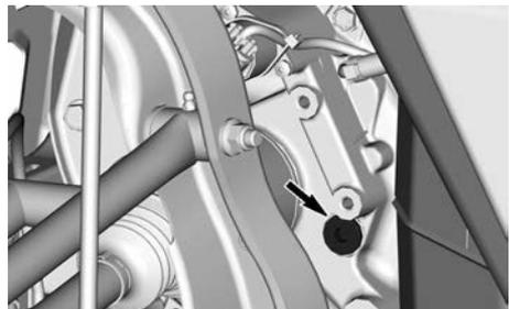
4. Entfernen Sie den Einfüllstopfen.
