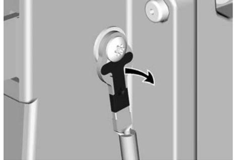
3. Heben Sie die Ladeklappen um 45° an.
