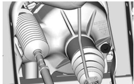
3. Entfernen Sie den Einfüllstopfen.
