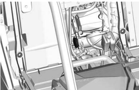
3. Entfernen Sie die Ölfilterabdeckung.
