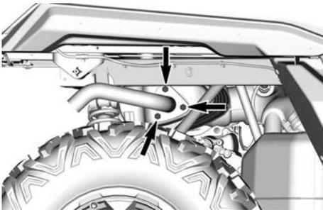
2. Entfernen Sie das Abgasrohr, die Dichtung (entsorgen) und den Funkenfänger.
