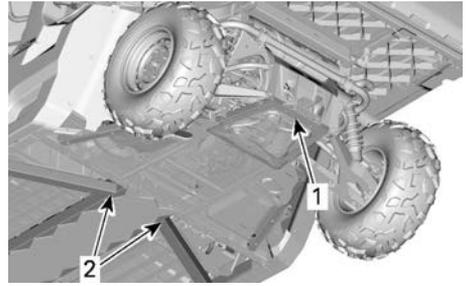
1. Hebestelle unter der Schutzplatte
