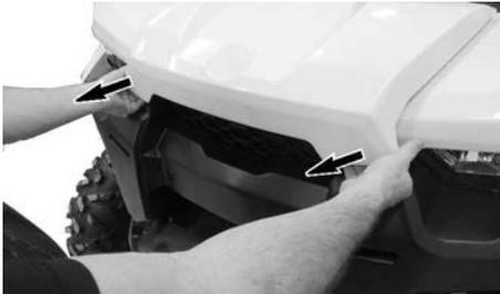
AN DEN VORDEREN KANTEN DER WARTUNGSABDECKUNG ZIEHEN.
