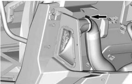
4. Entfernen Sie das Luftfiltergehäuse vom Fahrzeug.
