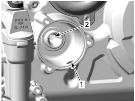
1. Einlass-Bohrung der Ölpumpe zum Ölfilter
