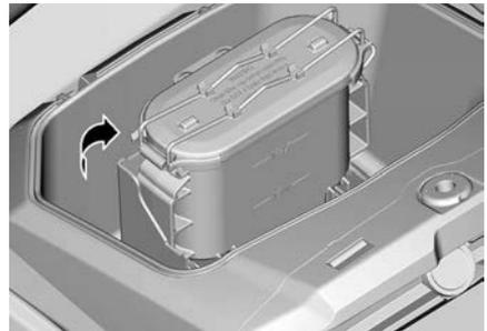
Füllen Sie Bremsflüssigkeit nach Bedarf auf. **Nicht überfüllen.**
