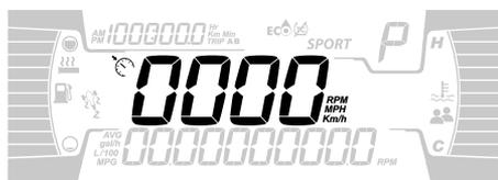
Muestra la velocidad del vehículo en km/h o mph.
