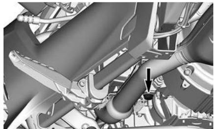
4. Coloque un recipiente debajo de la zona del tapón de drenaje magnético de la caja de cambios.
