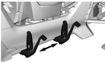
3. Tire del pedal de freno y colóquelo en la posición de funcionamiento.
