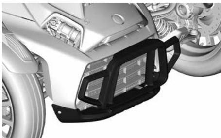
3. Desmonte los tornillos situados debajo de la protección frontal.
