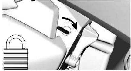
Para desbloquear la palanca de la posición de estacionamiento, gire la llave en sentido contrario al de las agujas del reloj.
