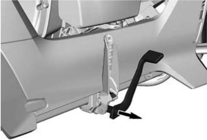
4. Baje el estribo y compruebe que el conductor pueda aplicar el pedal de freno en su recorrido completo.
