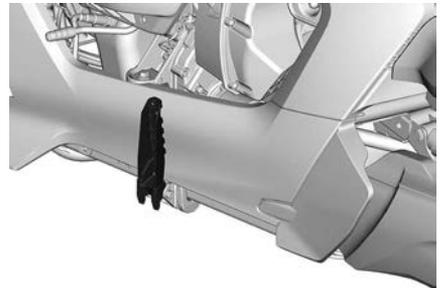
2. Deslice el estribo hacia adelante o hacia atrás a la posición deseada.
