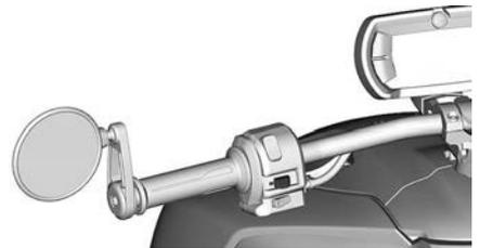
Las luces se apagan automáticamente tras un giro normal, pero puede que tenga que apagarlas manualmente si el giro es leve; por ejemplo, si la maniobra consiste en un cambio de carril.
