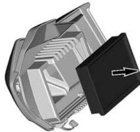
**Inspección del filtro de aire del motor**
