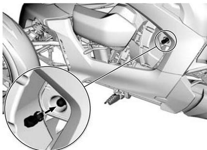
3. Pulse brevemente el botón de arranque para activar el sistema eléctrico.
