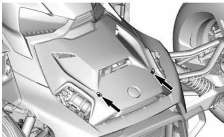
2. Levante la parte delantera de la cubierta y deslícela hacia delante.
