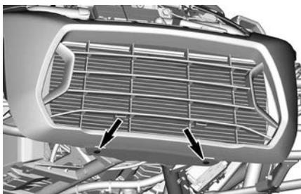
4. Enrolle hacia arriba las prolongaciones de la protección delantera para soltar las pestañas de sujeción traseras.
