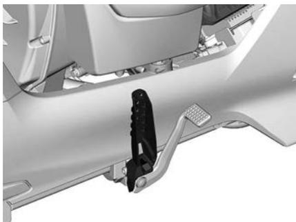
2. Deslice el estribo y el pedal de freno hacia adelante o hacia atrás a la posición deseada.
