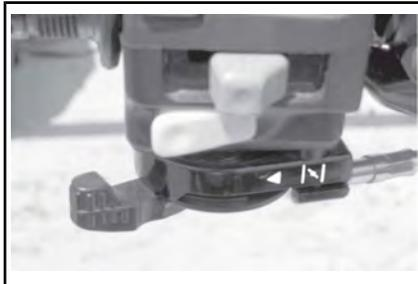
CONFIGURAZIONE TIPICA — LEVA DEL DISPOSITIVO DELL'ARIA IN POSIZIONE FULL
