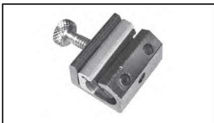
Inserire il beccuccio dello spray nel foro del lubrificatore per cavi.
