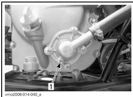
1. Bouchon de vidange du système de refroidissement
