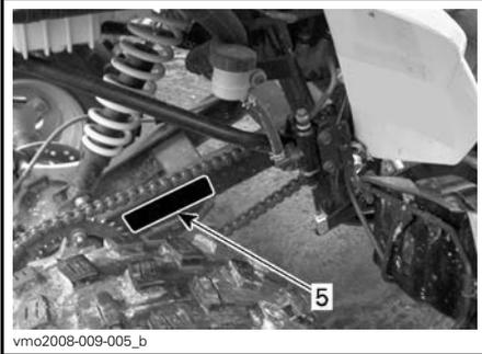
5. Emplacement de l'étiquette de réglage de la chaîne d'entraînement
