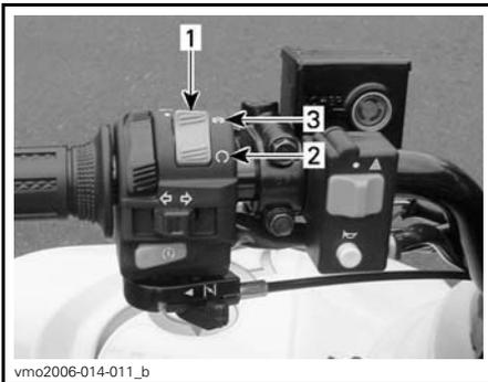
1. Interrupteur d'arrêt d'urgence du moteur
