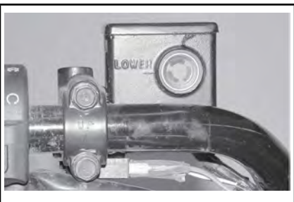
TÍPICO — DEPÓSITO DE LÍQUIDO DE FRENOS DE LA PARTE TRASERA, EN EL LADO IZQUIERDO
