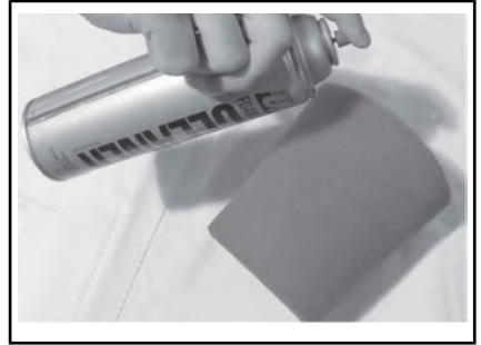
TÍPICO - ROCÍE EL ELEMENTO DE FILTRO POR DENTRO Y POR FUERA.
