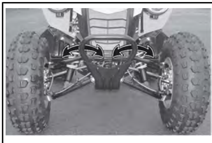
TÍPICO - UBICACIONES DE LAS CORREAS EN EL PARACHOQUES DELANTERO
