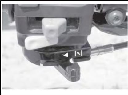
*CHOKE GEÖFFNET, HEBEL IN UNBETÄTIGTER STELLUNG*
