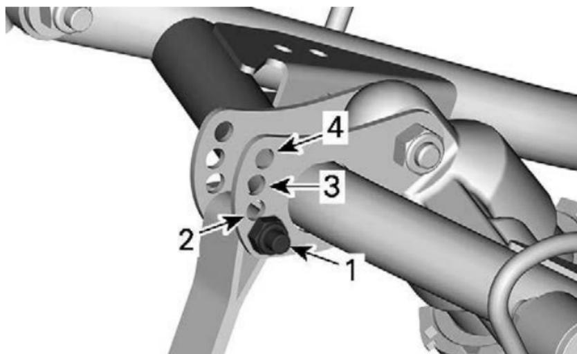
**POSITIONS DE LA COURROIE D'ARRÊT**
