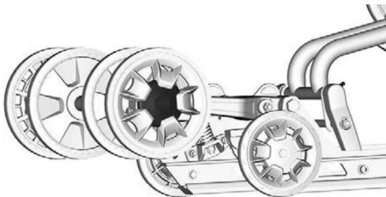
5. Desserrez les vis de retenue des roues intermédiaires arrière.
