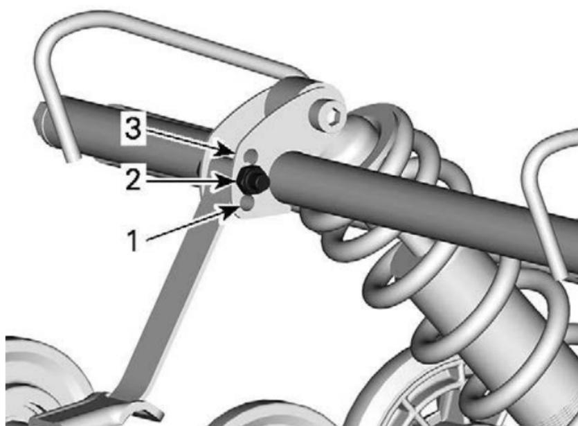
**POSITIONS DE LA COURROIE D'ARRÊT**
