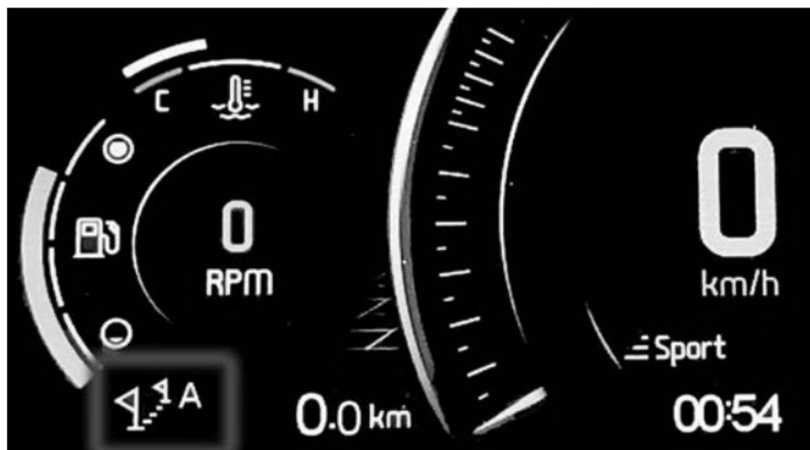
4. Appuyez rapidement et répétitivement sur le commutateur des **feux de croisement/ route**, et **simultanément** appuyez et maintenez enfoncé le bouton de **réduction du volume/annulation d'appel** jusqu'à ce que le message suivant apparaisse à l'écran.
