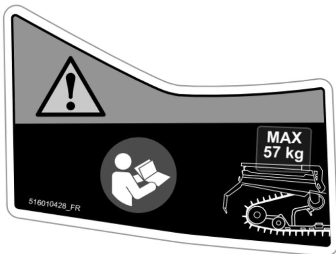
**CAPACITÉ DE CHARGE MAXIMALE - ÉTIQUETTE D'AVERTISSEMENT**
