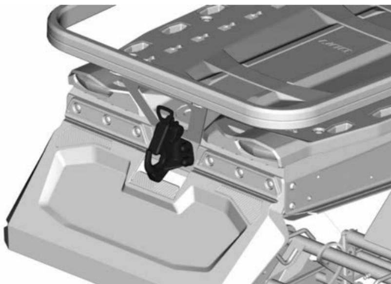
Pour ouvrir le crochet, poussez et tournez la poignée pour sortir la plaque de verrouillage.
