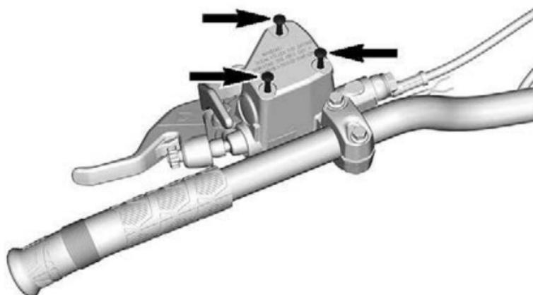
3. Retirez le bouchon de réservoir.
