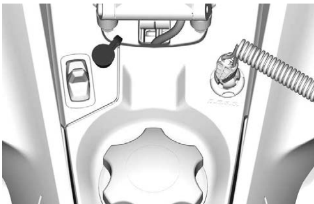
CONDUCTEUR - EMBLACEMENT PRISE DE VISIÈRE ÉLECTRIQUE
