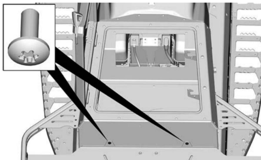
8. Entfernen Sie diese Schraube auf beiden Seiten.
