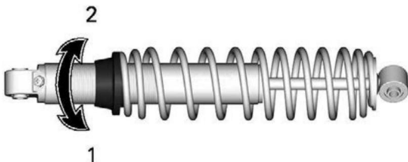
1. *Vorspannung erhöhen*
