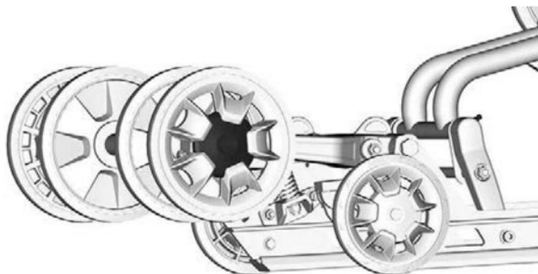
5. Lösen Sie die Halteschrauben der hinteren Zwischenräder.
