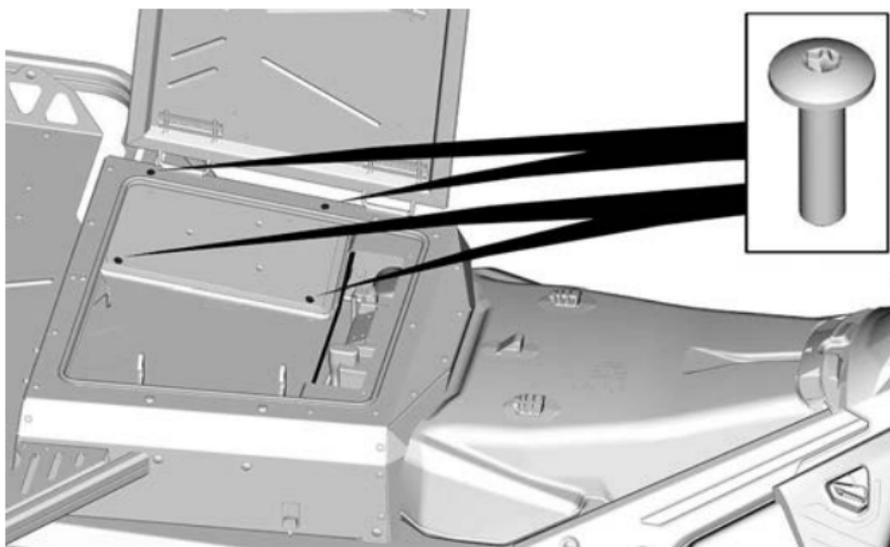
5. Drehen Sie die Platte, um Zugang zu den Anschlüssen auf der Rückseite zu erhalten.
