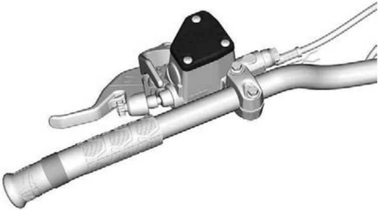
2. Entfernen Sie die Halteschrauben des Behälterdeckels.
