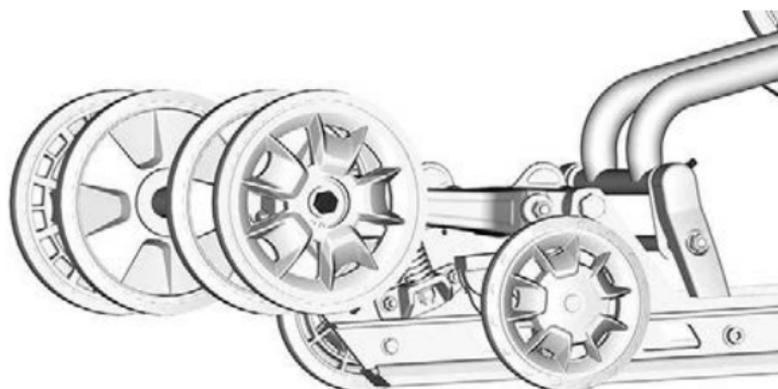
6. Ziehen Sie die beiden Einstellungsschrauben zum Erhöhen der Raupenspannung an und lösen Sie die Einstellungsschrauben zum Verringern der Raupenspannung.
