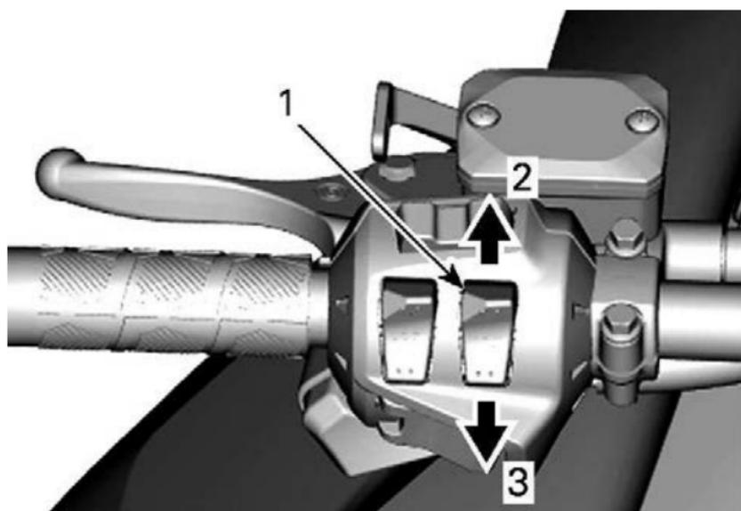
1. *Schalter für Arbeitslicht und Blinkleuchte*
