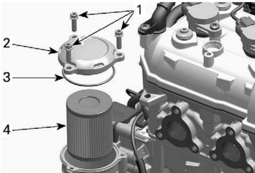
1. Schrauben der Ölfilterabdeckung
