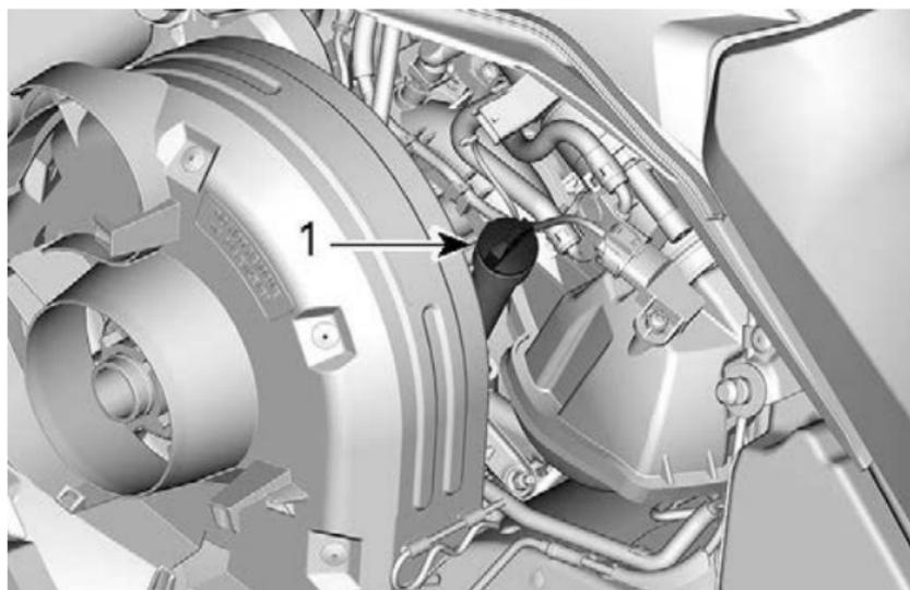
**LINKE SEITE DES FAHRZEUGS****1. Öltank-Messstab**
