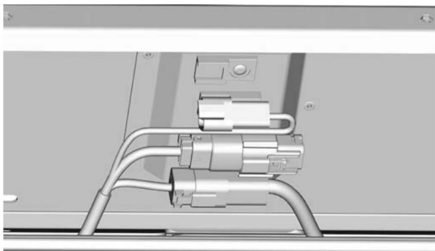
6. Lösen Sie die Steckverbinder von der Halterung und ziehen Sie den Stecker des Rücklichts ab.
