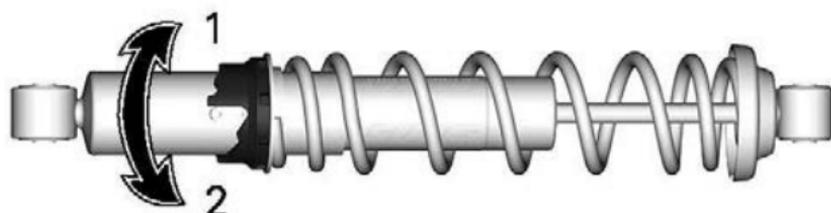
1. Vorspannung erhöhen
