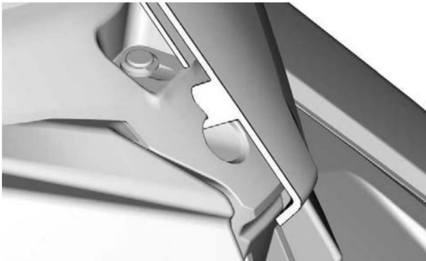
3. Befestigen Sie die Windschutzscheibe, indem Sie deren Stifte in die Durchgangsstülen stecken.
