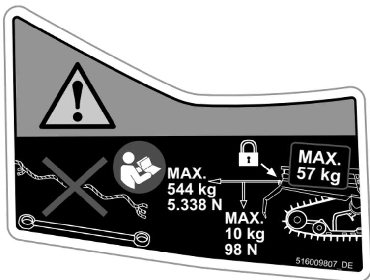
**RANGER PRO - MAXIMALE ZULADUNG UND ZUGLAST -
