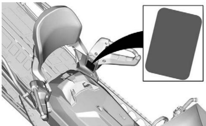
**Charge cargo maximale et capacité de remorquage - Étiquette d'avertissement**
