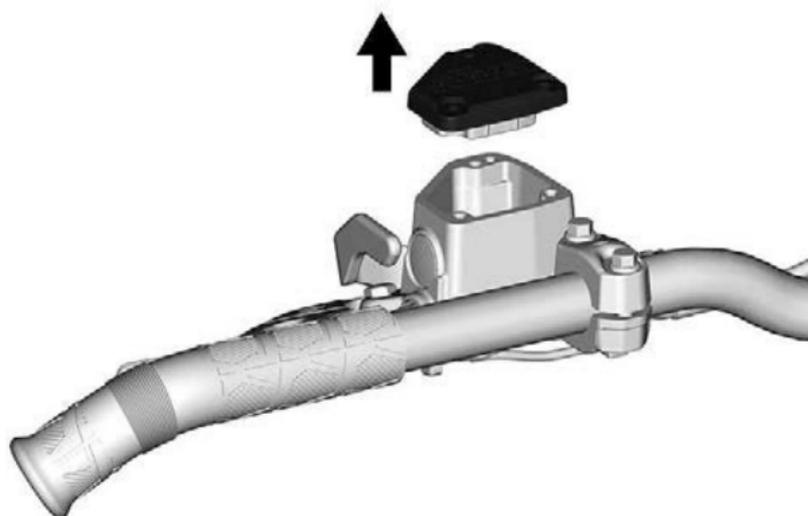
4. Ajoutez du liquide au besoin. Évitez tout remplissage excessif. Utilisez uniquement le fluide de frein recommandé.
