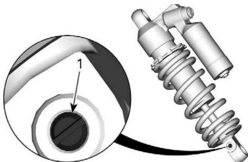
1. Dispositif de réglage de l'amortissement des rebonds
