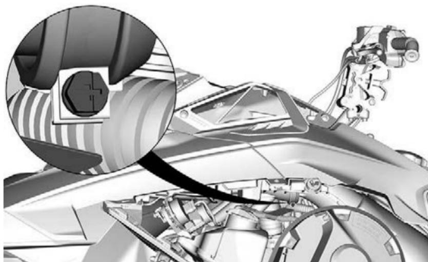
9. Retirez les vis de fixation du module de carrosserie supérieur des deux côtés.
