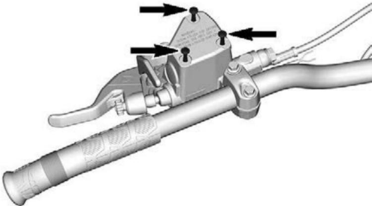
3. Retirez le bouchon de réservoir.
