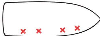
Mauvaise répartition (trop chargée à tribord) KC-1340.1
