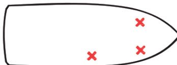
Mauvaise répartition (trop chargée sur la proue) KC-1330.1
