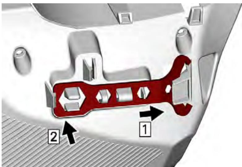
3. Far scorrere il dispositivo di espansione della puleggia e l'estremità corta dello strumento di regolazione fari nel foro.
