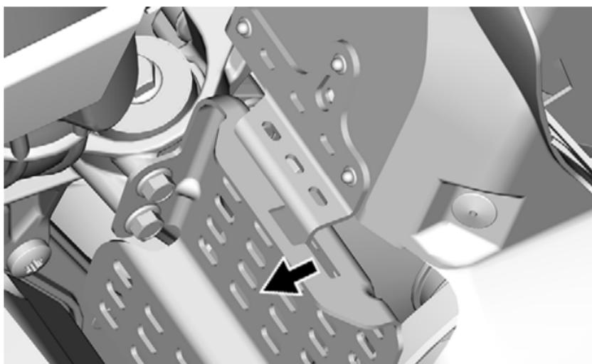
3. Posizionare la parte posteriore della protezione cinghia sopra il fermo e assicurarla mediante il perno di blocco.
