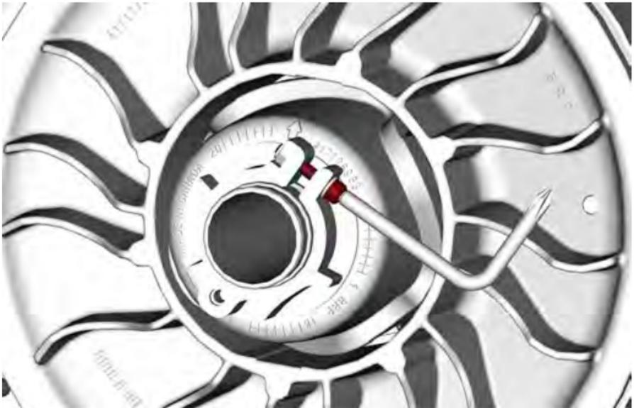
2. Utilizzando lo strumento di regolazione delle sospensioni fornito nel kit degli attrezzi, girare l'anello di regolazione di 1/4 di giro alla volta, quindi ruotare la puleggia condotta per installare correttamente la cinghia tra le gole della puleggia.
