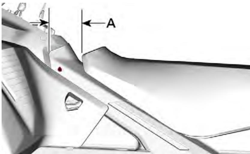
– A = Quanto basta per disinnestare il sedile dal serbatoio del carburante
