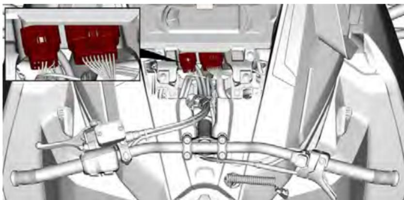
4. Rimuovere le viti di fissaggio del modulo superiore della scocca su entrambi i lati.
