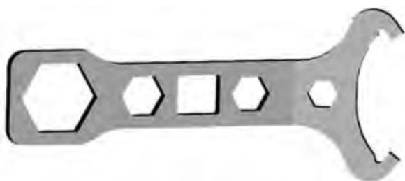
**STRUMENTO DI REGOLAZIONE DELLE SOSPENSIONI**
