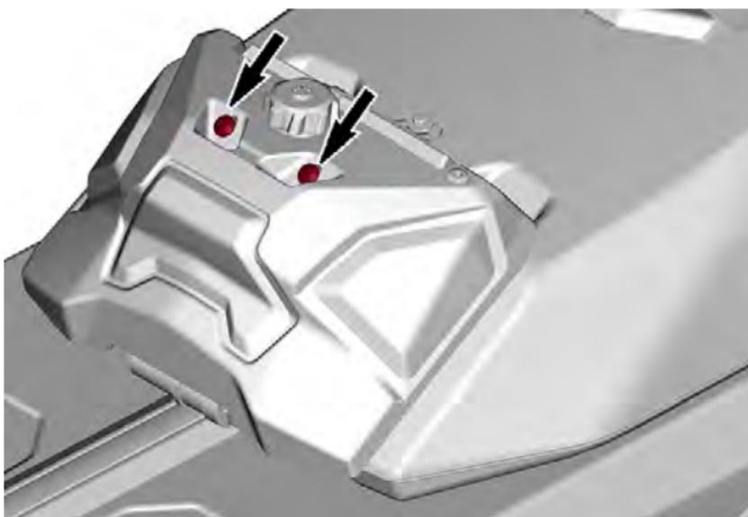
2. Inclinare il serbatoio del liquido ICE verso la parte posteriore per accedere alla batteria.
