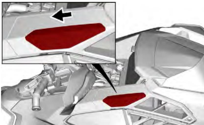
5. Rimuovere i seguenti dispositivi di fissaggio quindi il filtro dell'aria DX.
