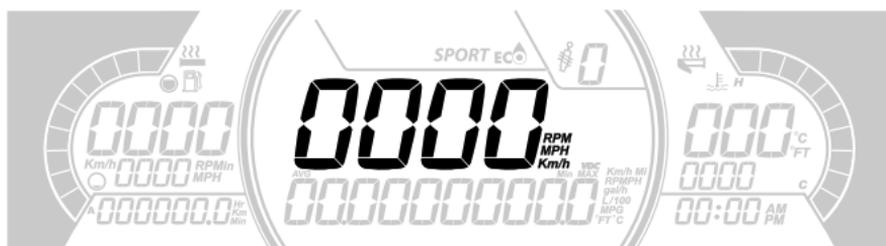
Anzeige der Fahrzeuggeschwindigkeit in km/h (oder mph) oder der Drehzahl in U/min. Siehe *Einstellungen*.
