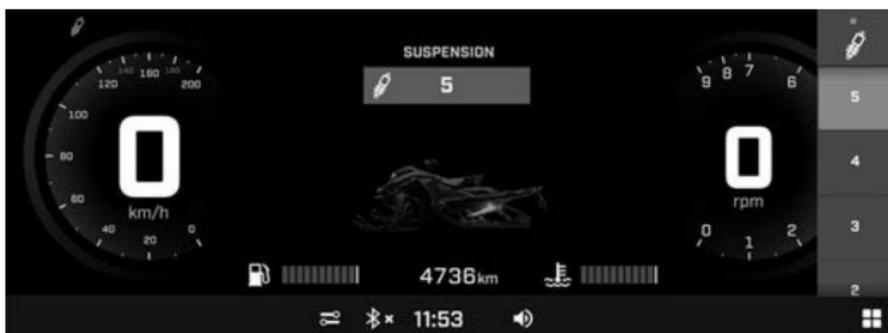
6. Verwenden Sie den Berührungsbildschirm oder die Pfeiltasten Nach oben/Nach unten des Multifunktionsschalters, um die Federungsstufe zu ändern.
