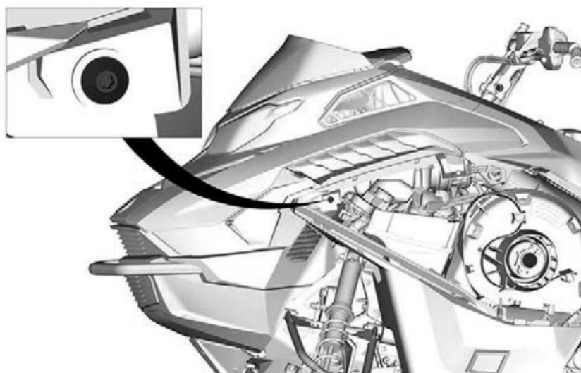
5. Lösen Sie die Schelle des Lufteinlasskanals.
