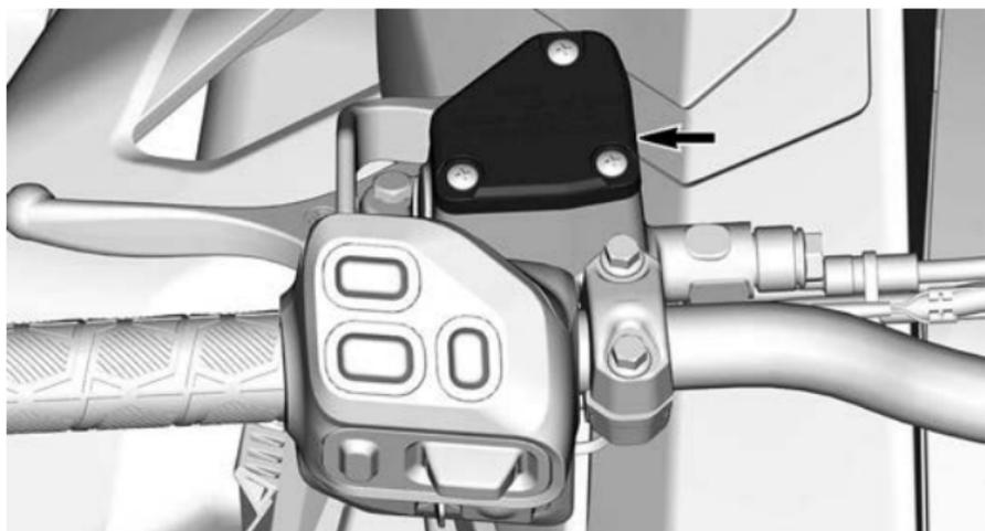
2. Entfernen Sie die Halteschrauben des Behälterdeckels.
