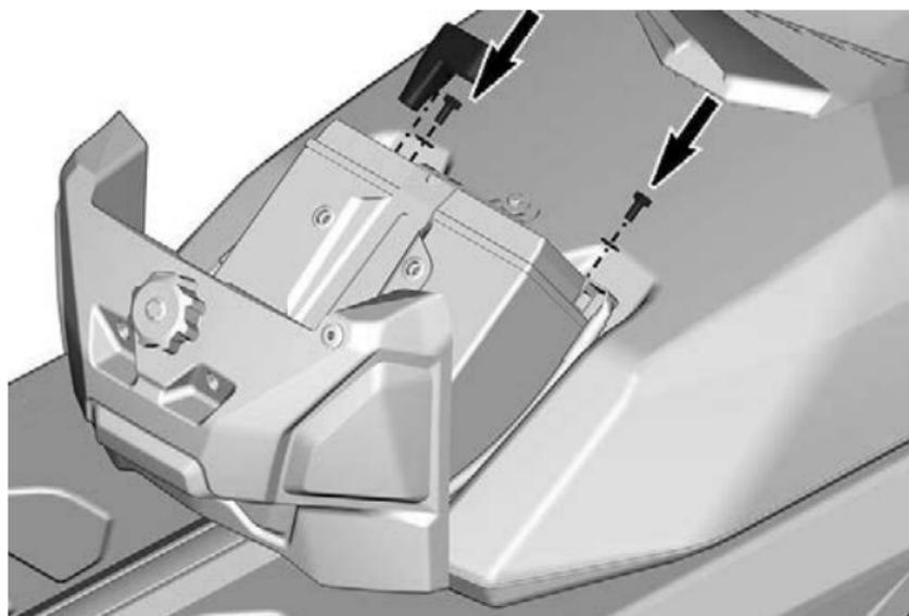
4. Entfernen Sie die Schraube, die den Batteriehaltebügel sichert.
