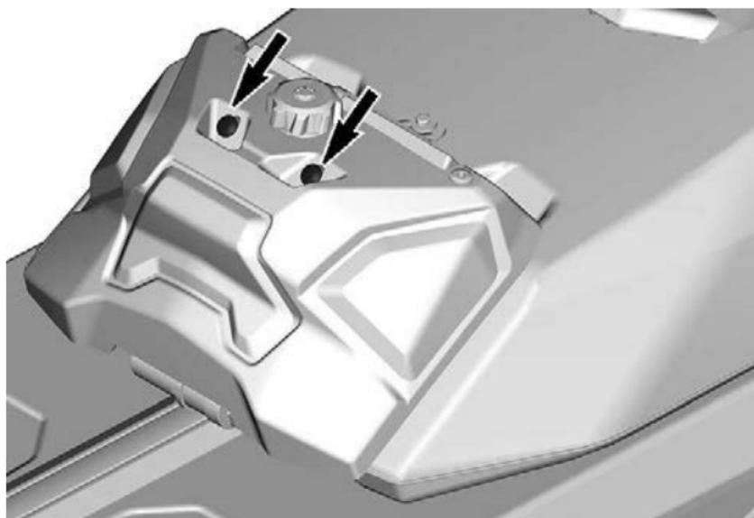
2. Kippen Sie den ICE-Flüssigkeitsbehälter nach hinten, um Zugang zur Batterie zu erhalten.
