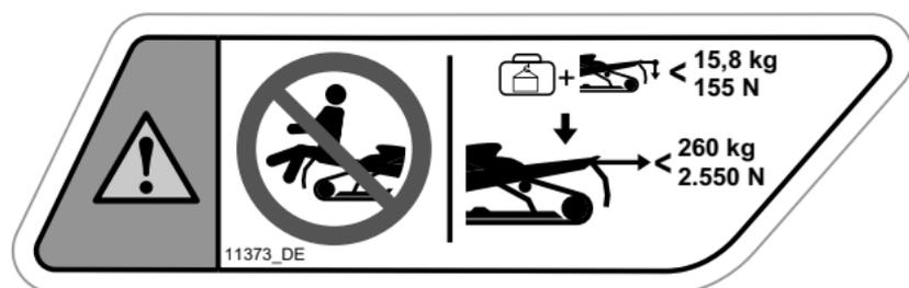
**MAXIMALE ZULADUNG UND ZUGLAST - WARNSCHILD**
