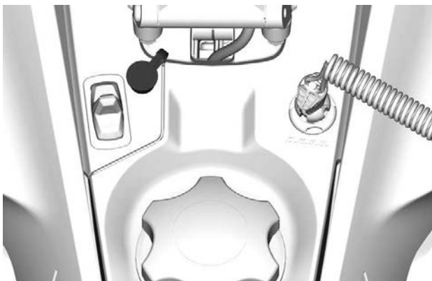
CONDUCTEUR - EMBLACEMENT PRISE DE VISIÈRE ÉLECTRIQUE
