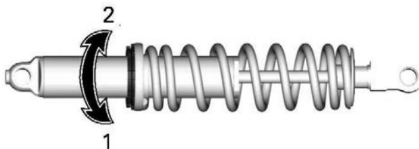
1. Vorspannung erhöhen
