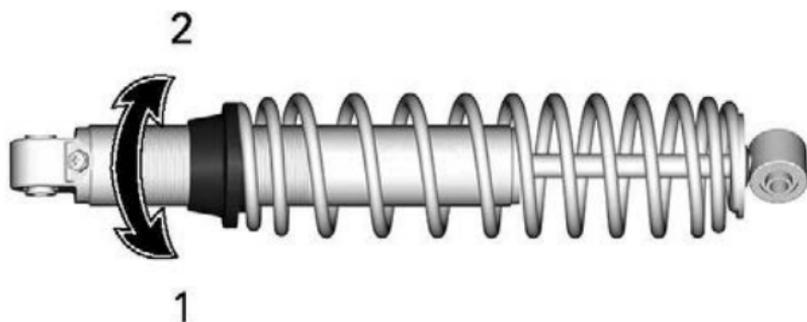
1. Vorspannung erhöhen
