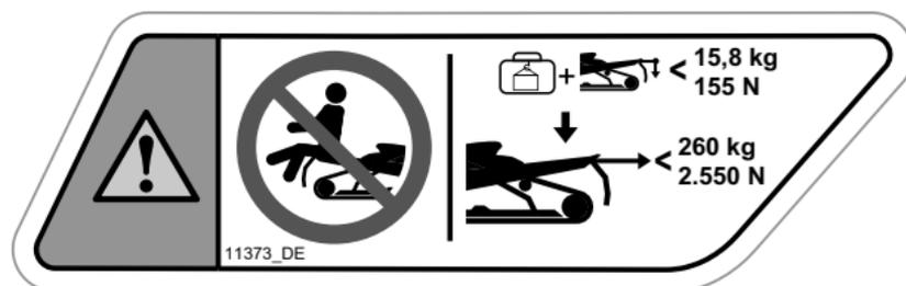
MAXIMALE ZULADUNG UND ZUGLAST - WARNSCHILD
