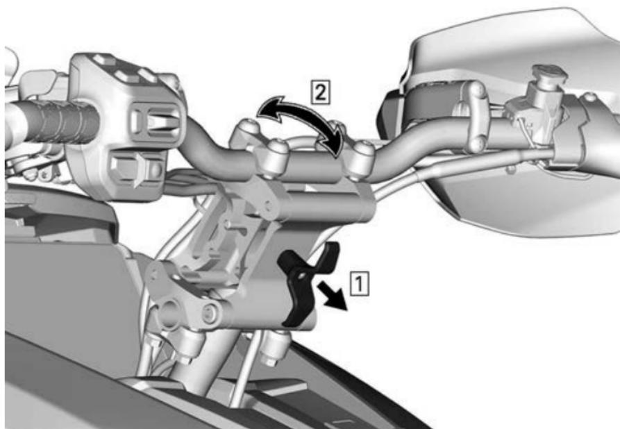
*Schritt 1. Hebel ziehen*
