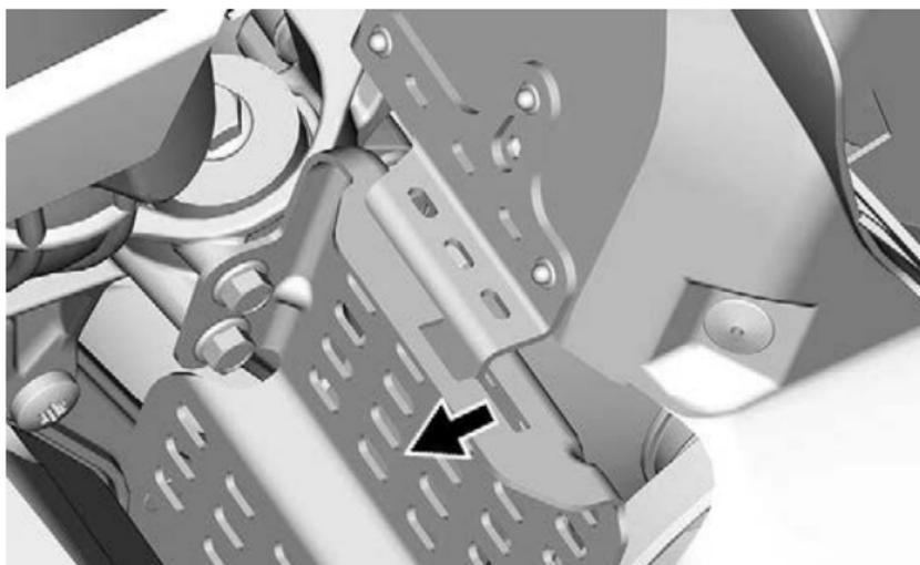
3. Setzen Sie die Lasche der Riemenabdeckung zwischen der unteren Wanne und dem Haken ein.
