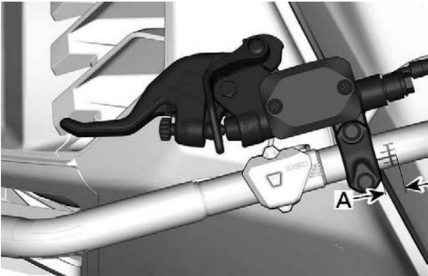
A. 0 bis 9 mm (0 bis 0.354 Zoll) zwischen dem Beginn der Lenkstangenmarkierung und der Seite des Bremshebels
