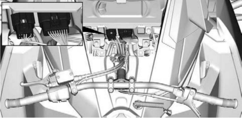
4. Entfernen Sie die Halteschrauben des oberen Karosseriemoduls auf beiden Seiten.
