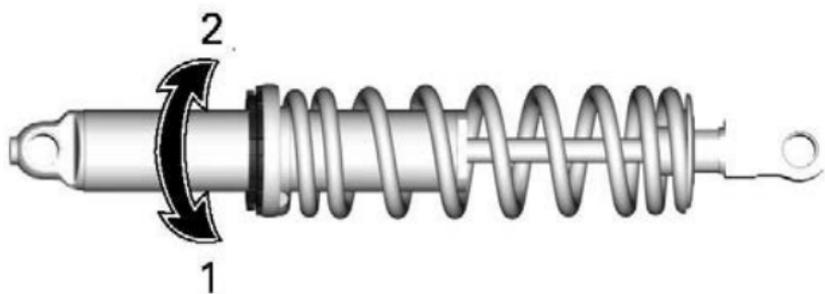
1. *Vorspannung erhöhen*
