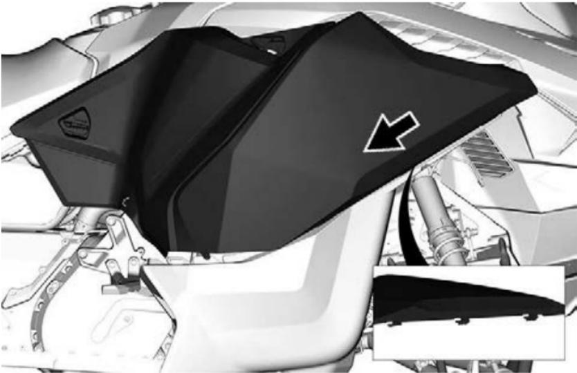
2. Schwenken Sie die Seitenverkleidung auf das Fahrzeug.
