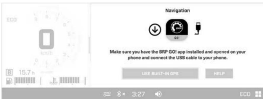
Wenn eine oder mehrere Karten direkt auf das 10,25 Zoll Touchscreen-Farbdisplay heruntergeladen werden, können Sie mit der Option „Integriertes GPS verwenden“ darauf zugreifen, ohne ein Handy anschließen zu müssen. Verwenden Sie die Option „Hilfe“ für die Fehlerbehandlung.
