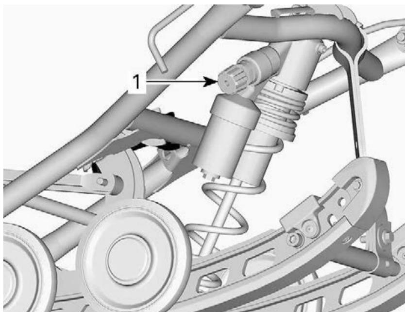
1. Einstellknopf für Kompressionsdämpfung des mittleren Stoßdämpfers
