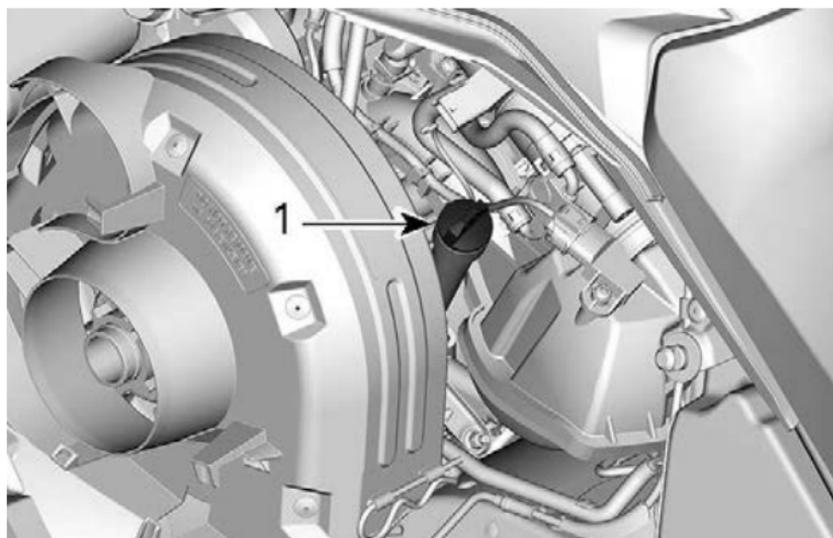
**LINKE SEITE DES FAHRZEUGS****1. Öltank-Messstab**
