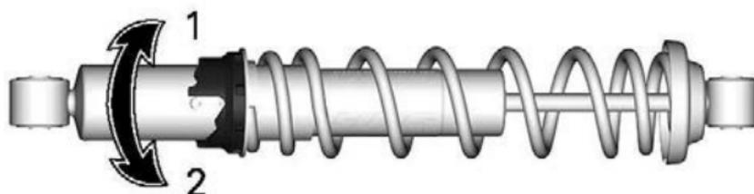
1. Vorspannung erhöhen
