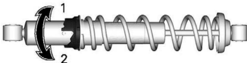
1. *Vorspannung erhöhen*
