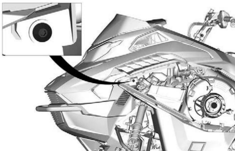
5. Lösen Sie die Schelle des Lufteinlasskanals.
