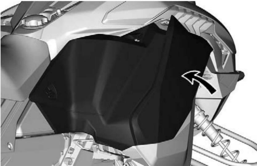
3. Sichern Sie die Seitenverkleidung mit den Verriegelungen.
