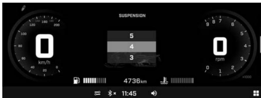
**Ändern Sie die Federungsstufe mithilfe der Fahreinstellungstaste**
