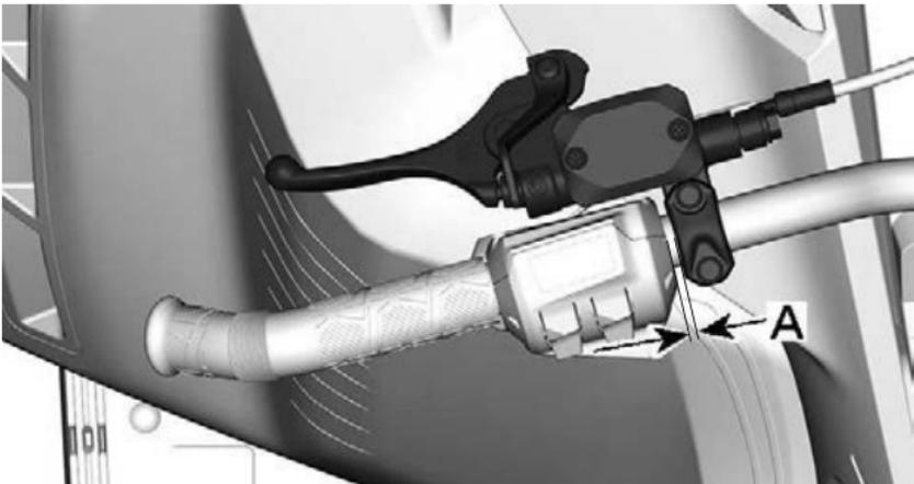
A. 0 bis 15 mm (0 bis 0.590 Zoll) zwischen dem Beginn der Lenkstangenmarkierung und der Seite des Bremshebels
