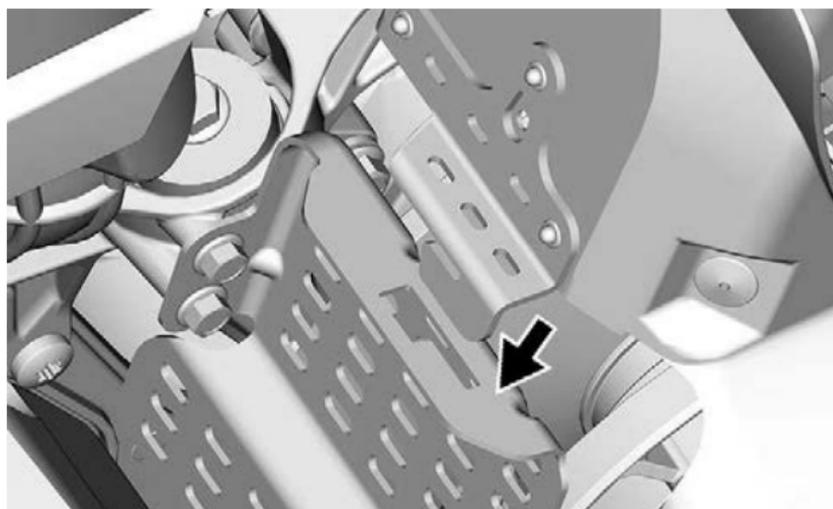
2. Schieben Sie die Antriebsriemenabdeckung in Richtung Motor und dann in Richtung der Fahrzeugfront.
