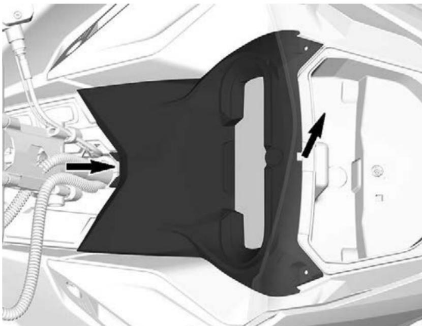
5. Klemmen Sie den Steckverbinder der Anzeige ab und entfernen Sie die Halterung.
