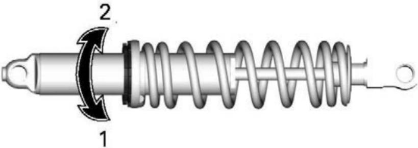
1. *Vorspannung erhöhen*
