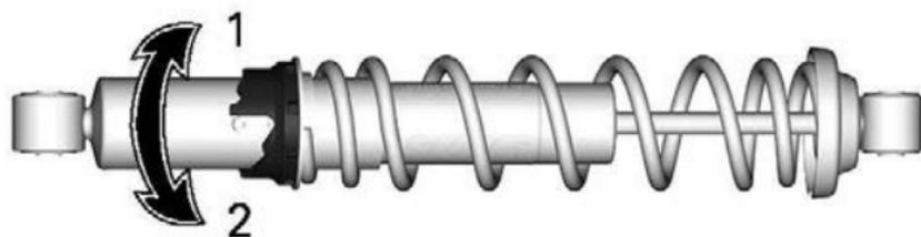
1. *Vorspannung erhöhen*
