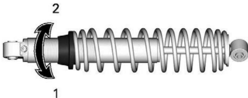
1. *Vorspannung erhöhen*
