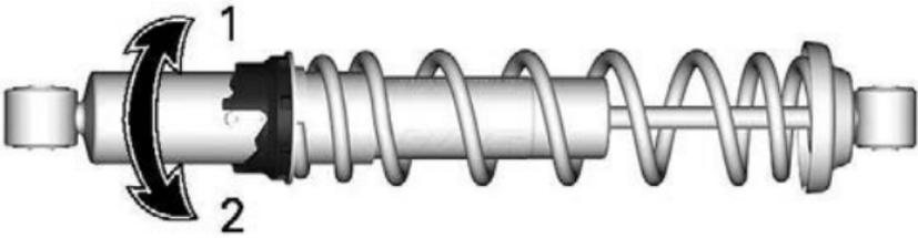
1. *Vorspannung erhöhen*
