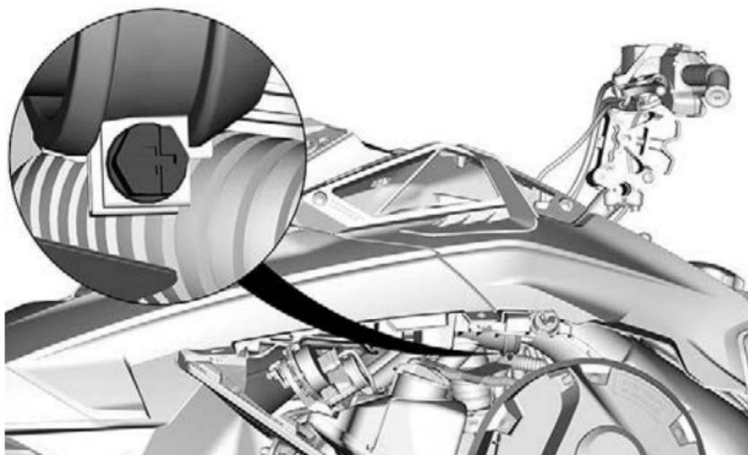
10. Entfernen Sie die Halteschrauben des oberen Karosseriemoduls auf beiden Seiten.
