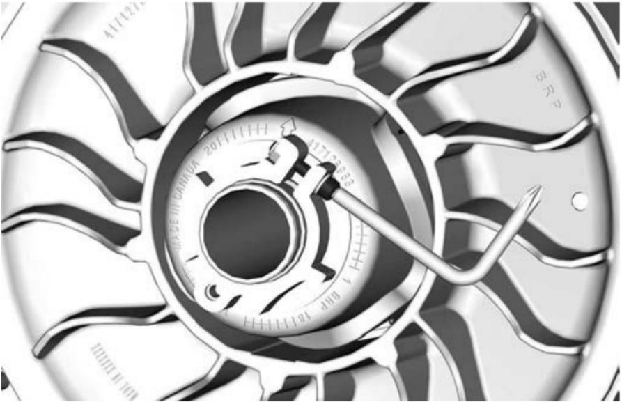
2. Drehen Sie den Ring mit der zum Lieferumfang gehörenden Vorrichtung zur Einstellung der Aufhängung jeweils um eine Viertelumdrehung und drehen Sie dann die Abtriebscheibe, damit der Antriebsriemen zwischen den Scheiben den richtigen Sitz findet.
