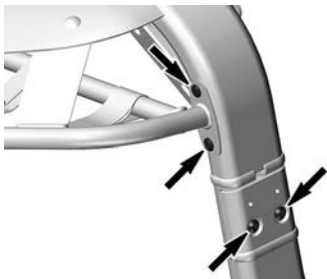
TORNILLOS DE LA ESTRUCTURA FRONTAL DEL TOLDO BIMINI — LADO IZQUIERDO (LH)
