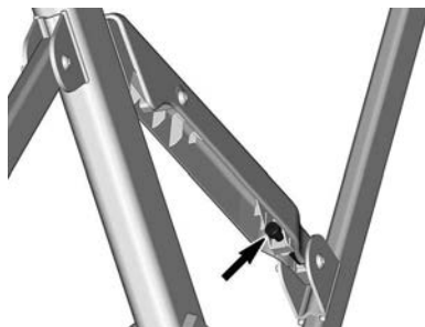
PERNO DE TENSION DEL TOLDO BIMINI — LADO IZQUIERDO (LH)
