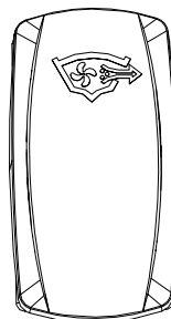
INTERRUPTOR DEL VENTILADOR DE LA SENTINA
