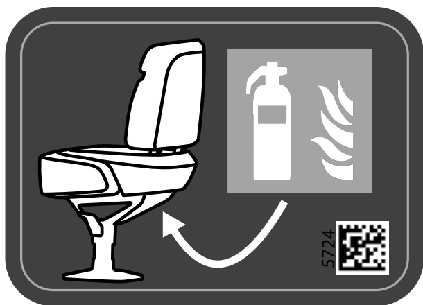
ETIQUETA DE POSIÇÃO DO EXTINTOR DE INCÊNDIO
