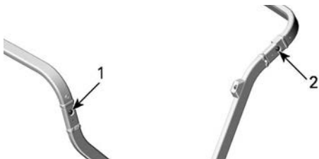
PARAFUSOS DO MEIO E TRASEIRO DA ESTRUTURA DO TOLDO – LADO ESQUERDO
