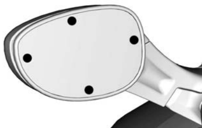
JUSTERINGSPUNKTER FOR SPEIL – STD- OG S-MODELLER
