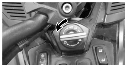
NYCKELLÄGE FÖR ATT LÅSA STYRET
