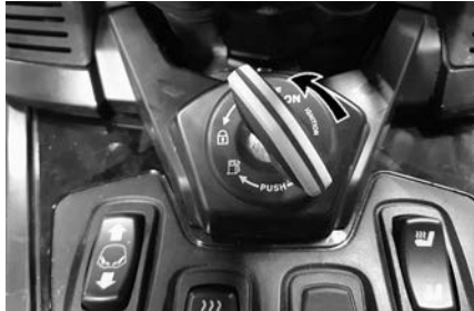
NØKKELSTILLING VED ÅPNING AV OPPBEVARINGSROM FORAN
