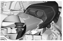
TYPICAL - ALIGNING PANELS PROPERLY
