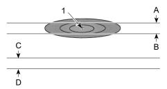
TYPICAL – HEADLIGHT REFLECTION ON TEST SURFACE – HIGH BEAM
