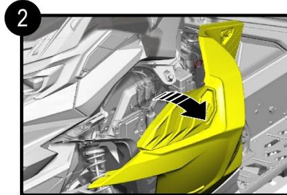
Tirez vers le haut pour désengager les languettes du panneau et retirez-le du véhicule.
