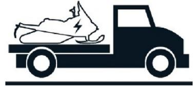
Il est recommandé d'utiliser un camion à plateau ou un véhicule de transport comparable pour éviter tout mouvement de la chenille. Le véhicule doit être sanglé sur la plateforme, face à l'avant, en attachant des sangles sur les jambes des skis (et pas sur les skis) et la suspension arrière.
