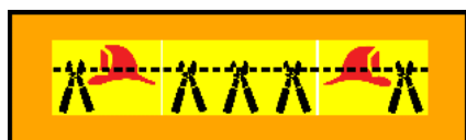
First responder cut loop (kabelsnitt)
