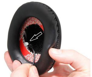
A.5. Passe a conexão do alto-falante pelo orifício na parte de trás do NCS para que ela aponte para a parte traseira do capacete.
