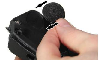
**3.** Posicione o microfone no Velcro™ instalado na etapa anterior no lado direito interno do capacete e oriente os diferentes fios para mantê-los fora de alcance.
