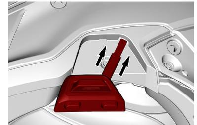
7. Stellen Sie sicher, dass die Lasche der Benutzeroberfläche neben dem Kabel im rechteckigen Loch eingerastet ist.
