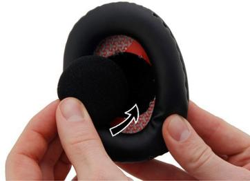
**A.7.** Setzen Sie die Geräuschdämpfung wieder in den Helm und achten Sie darauf, dass sich die Öffnungen unten am Helm befinden und das Lautsprecherkabel hinten zum Helm zeigt.
