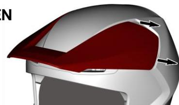
2. Zum Ausbau des Schirm-Drehgelenks stecken Sie einen Schraubendreher in das größere der beiden Löcher und hebeln Sie das Drehgelenk vorsichtig heraus.
