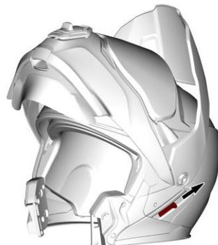
2. サンバイザーをヘルメットインナーとアウターシェル間に挿入し、両側の位置決めペグに取り付けます。
