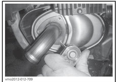
**TYPISCH - ABGASROHR ENTFERNEN**
