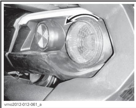
**RÜCKLEUCHE ZUM ENTFERNEN GEGEN DEN UHRZEIGERSINN DREHEN**
