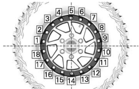
TYPIQUE - SÉQUENCE DE SERRAGE FINAL
