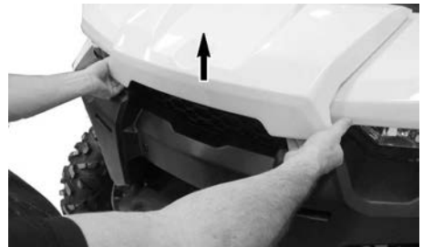
LØFT PÅ KANTEN PÅ SERVICEDEKSELET FORAN.
