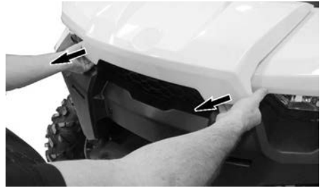
TREKKEN AAN DE RAND VAN HET VOORSTE ONDERHOUDSDEKSEL.
