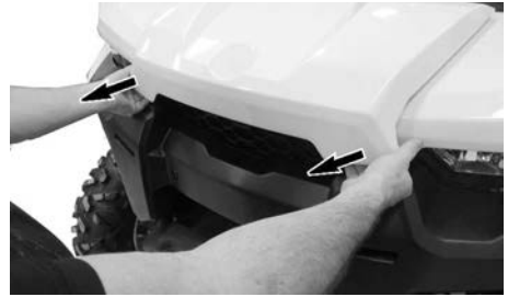
TIRE DEL BORDE DE LA TAPA DE ACCESO DELANTERA.
