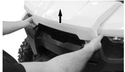
HOCHHEBEN DER WARTUNGSABDECKUNG.
