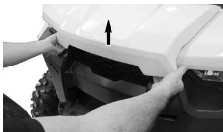
LYFT KANTEN PÅ SERVICEKÅPAN.
