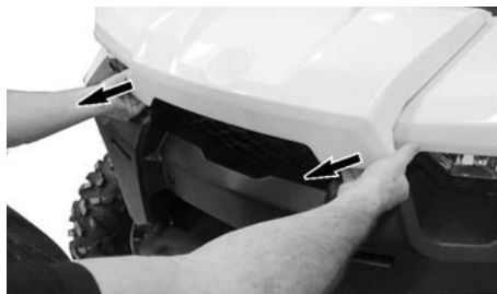
DRAG I KANTEN PÅ SERVICEKÅPAN.
