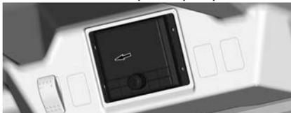
4. Em seguida, puxe com cuidado o feixe de fios para fora, assegurando-se de não danificar os fios ou conexões. Localize a tampa da caixa de fusíveis.
