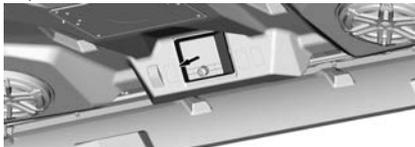
2. Remova e guarde os quatro parafusos M4 x 12 que prendem a unidade principal, conforme mostrado a seguir.
