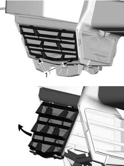
Limpe os filtros de ar lavando-os com água morna e sabão neutro. Remova o excesso de água e seque com secador de ar antes da instalação.
