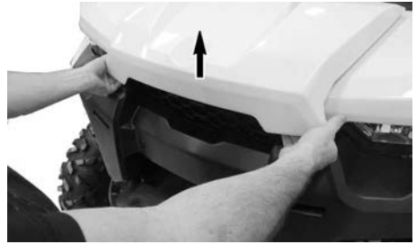
SOLLEVAMENTO DEL BORDO DEL COPERCHIO DI MANUTENZIONE ANTERIORE
