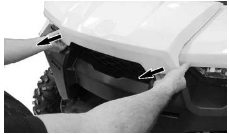
TIREZ SUR LE BORD AVANT DU COUVERCLE D'ENTRETIEN.
